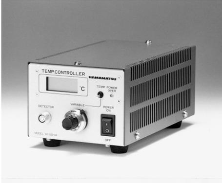
C1103-04は1段および2段電子冷却型のパッケージ内の電子冷却素子に流す電流を調整することによって、温度を一定に保ちます。温度調整つまみにより、素子温度を設定することが可能です。
